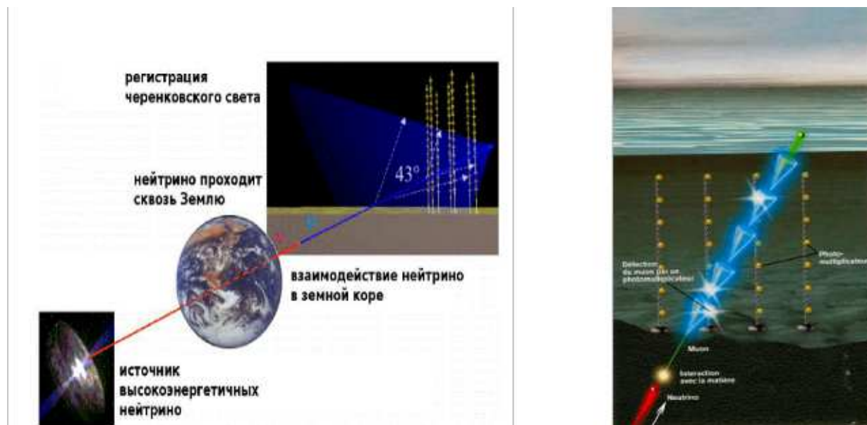
Рис. 1: Принцип работы детектора. Земля используется в качестве щита от космических мюонов
