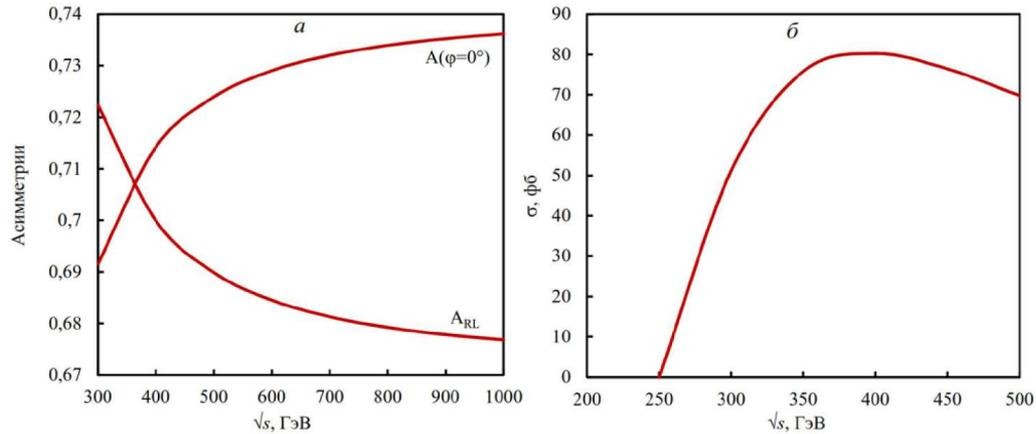
Рис. 7: *a* — Энергетическая зависимость поперечной и право-левой спиновых асимметрий при  $M_{H^-} = 125$  ГэВ; *б* — Зависимость сечения процесса  $e^-e^+ \rightarrow H^-H^+$  от энергии при  $M_{H^-} = 125$  ГэВ
