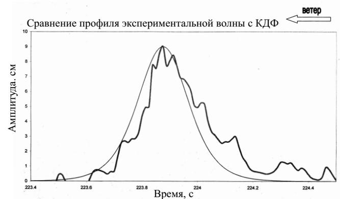
Рис. 1: Сравнение профиля ветровой уединенной волны в кольцевом канале с профилем, рассчитанным по уравнению КдВ
