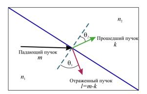
Рис. 1: Схема светоделителя.  $\theta_1$  и  $\theta_2$  — углы падения и преломления. Падает на границу раздела m фотонов, отражается l, а проходит k=m-l
