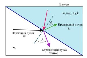
Рис. 2: Нелинейный светоделитель со второй нелинейной средой.  $\theta_1$  и  $\theta_2$  — углы падения и преломления. На первом входе когерентная мода с плоским волновым фронтом, а на втором - вакуум
