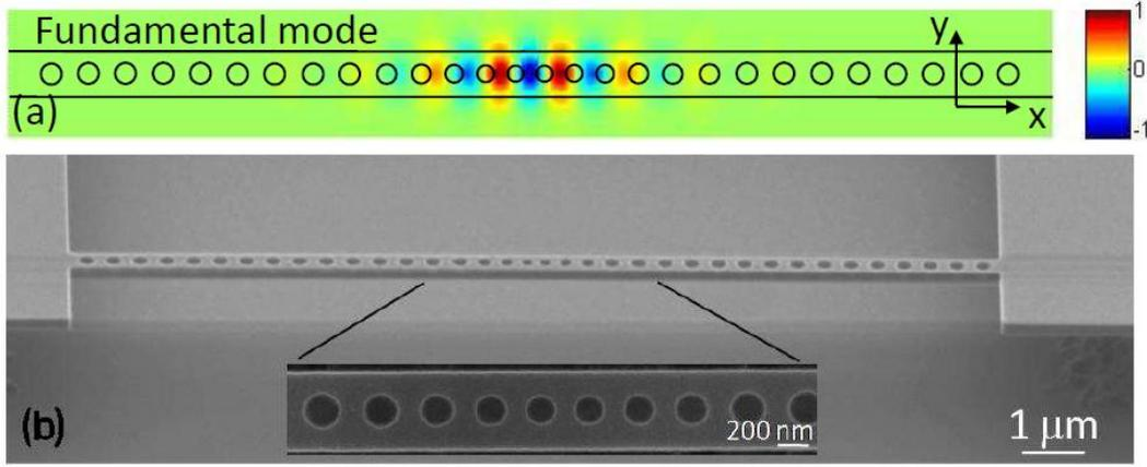
Рис. 1. Форма фундаментальной моды и фотография кристалла, изготовленного в [4]. Толщина перемычки  $2h = 220$  нм, толщина  $2h = 500$  нм, период фоксонного кристалла  $d = 430$  нм линейно уменьшается за  $k = 5$  отверстий до  $d_c = 330$  нм в центре резонатора. Радиусы отверстий составляют  $r = 0.28d$
