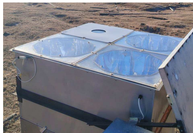
Рис. 3. Станция TAIGA-HiSCORE с блендой, установленной на один фотоумножитель
