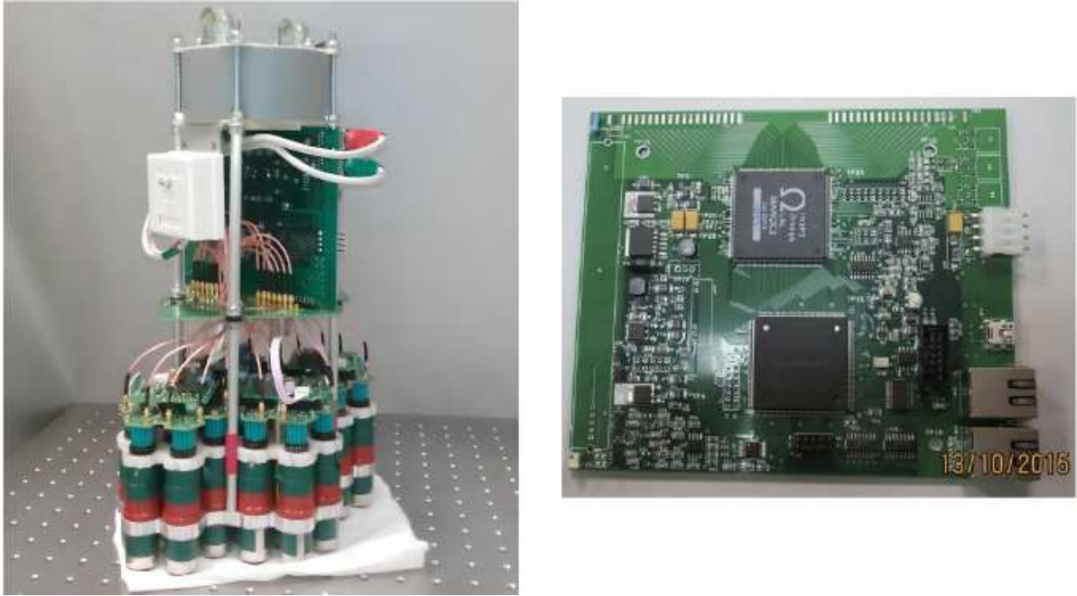
Рис. 2. Кластер из 28 фотоумножителей (слева) и микросхема MAROC (справа)
