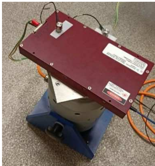
Рис. 1. Вибростенд на основе генератора вибраций «TIRA GmbH TV 51110»
