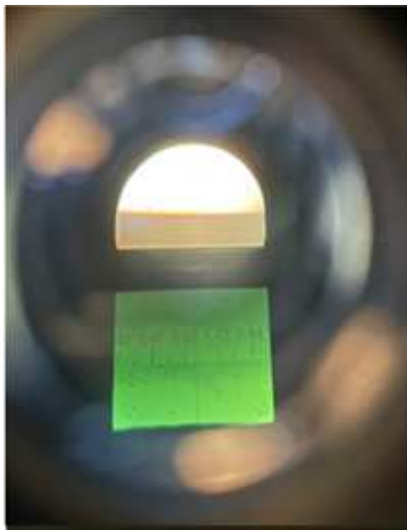
Рис. 4. Граница свет-тень и данные со шкалы рефрактометра от нижнего слоя смеси
