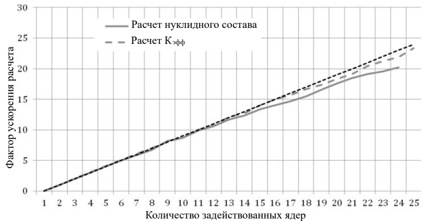
Рис. 1. Зависимость фактора ускорения расчётов от количества задействованных ядер. Источник: [9]
