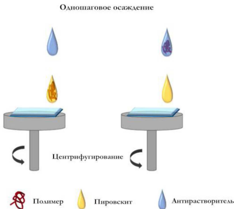
Рис. 1. Одностадийные методы осаждения для включения полимеров при изготовлении PSCs
