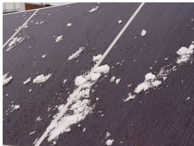
Рис. 2. Таяние снега на поверхности фотоэлектрического модуля
