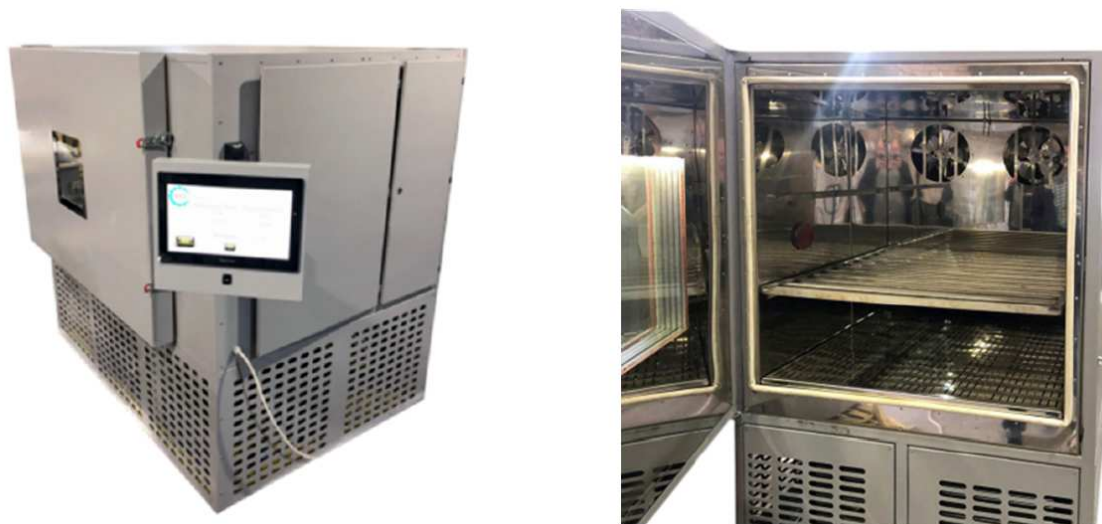
Рис. 3. Климатическая камера: а — внешний вид климатической камеры; б — внутреннее пространство камеры
