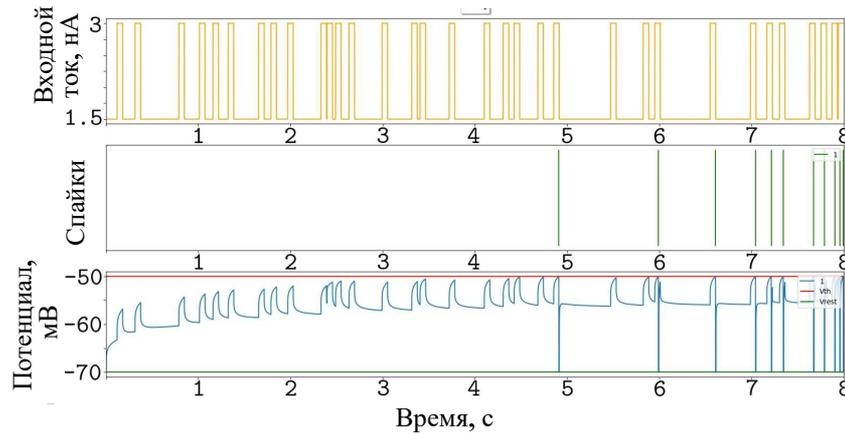
Рис. 4. Адаптация мембраны к входным импульсам с распределением Пуассона и ненулевым постоянным током. Время наблюдения — 8 с, длительность шага — 60 мс, амплитуда шага и постоянного тока равны 3 и 1.5 нА соответственно. Мембранный потенциал выражается в мВ
