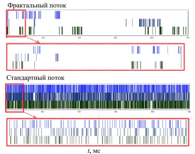
Рис. 3. Дробный и стандартный пуассоновский поток импульсов. Дробный обладает перемежаемостью, тогда как стандартный на больших временах является однородным
