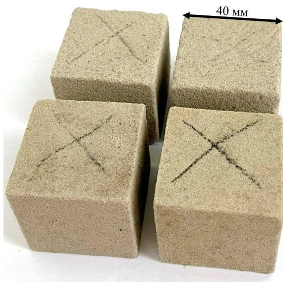
Рис. 1. Кубические образцы исследуемого ПХГ, изготовленные из кофейного материала
