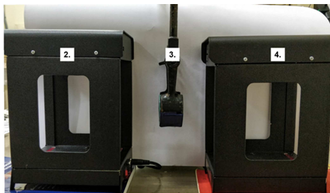
Рис. 3. Экспериментальный стенд. 1 — Пневматический ускоритель ПТ (не показан на рисунке); 2 — Хронограф-1 для определения входной скорости; 3 — Держатель образца; 4 — Хронограф-2 для определения выходной скорости; 5 — Поглотитель ПТ (не показан на рисунке)
