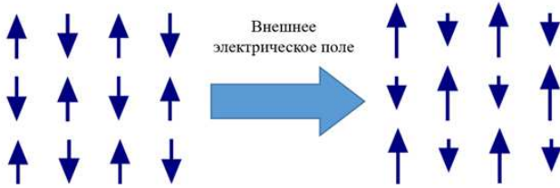
Рис. 1. Изменение структуры антиферромагнетика при приложении электрического поля
