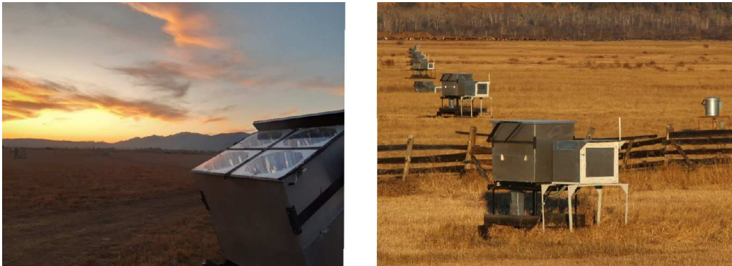
Рис. 3. Оптические станции установки TAIGA-HiSCORE
