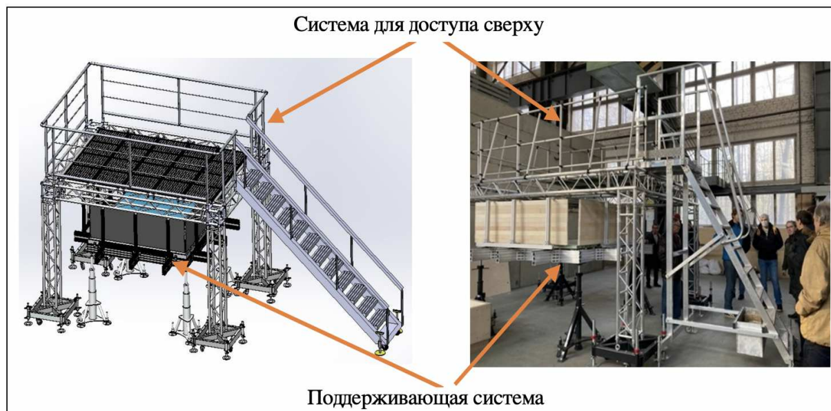
Рис. 11. Схема и фотография платформы для сборки детектора SuperFGD
