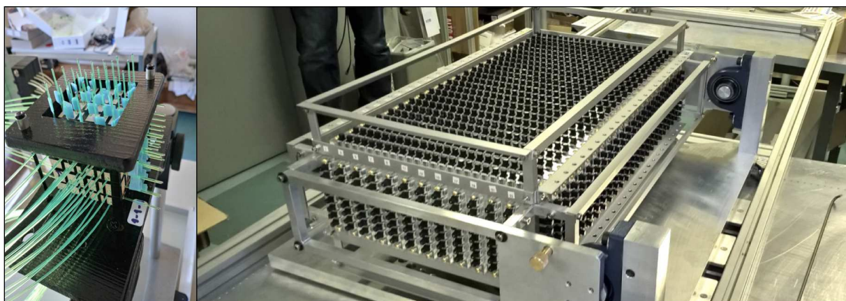
Рис. 10. Фотографии первого (слева) и второго (справа) прототипов детектора SuperFGD
