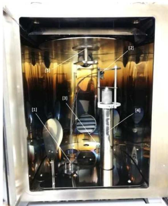
Рис. 7. Вакуумная камера: 1 — резистивный испаритель Sr, 2 — кварцевый резонатор, 3 — резистивный испаритель CsI, 4 — штатив, 5 — вращающаяся подложка с держателем. Синим закрасены части корпуса прототипа детектора
