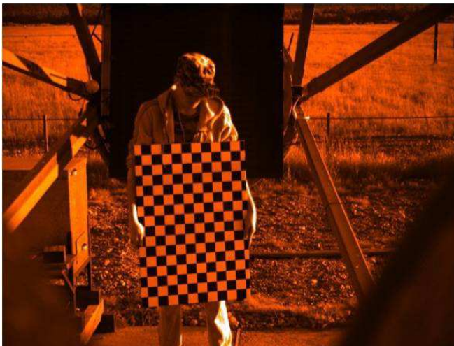
Рис. 4. Пример изображения, использующегося для калибровки камеры
