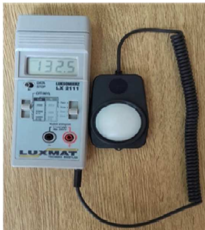
Рис. 2. Люксметр LX 2111, с помощью которого проводились измерения
