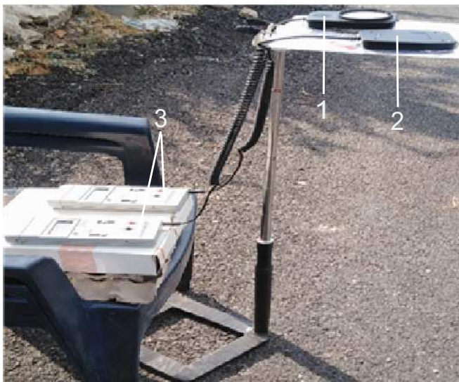
Рис. 3. Схема измерения интенсивности солнечного излучения
