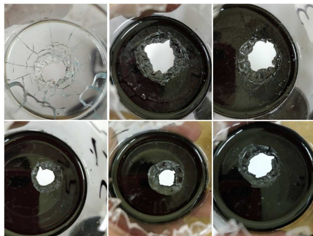
Рис. 4: Опытные образцы первого типа (слева направо сверху вниз: 0%, 1%, 3%, 5%, 7%, 10%) после ударного воздействия ускоренного снаряда
