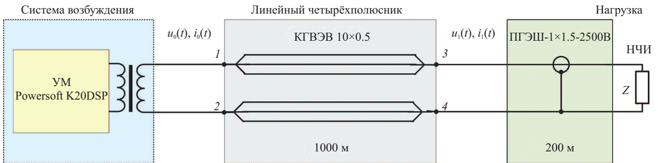
Рис. 3: Электрическая принципиальная схема включения кабеля связи и нагрузки
