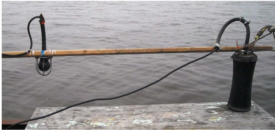
Рис. 1: НЧИ продольно-изгибного типа с закреплённым измерительным гидрофоном и кабелем связи перед погружением для проверки электроакустических параметров
