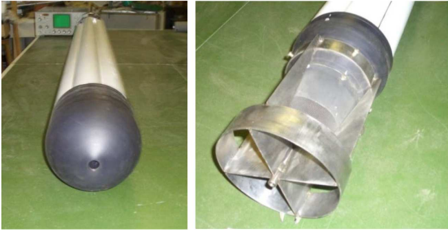
Рис. 1: Фотографии векторно-скалярной антенны с оболочкой. Слева — оголовник, справа — кормовая оконечность. Антенна имеет высоту 145 см, внешний диаметр 18 см
