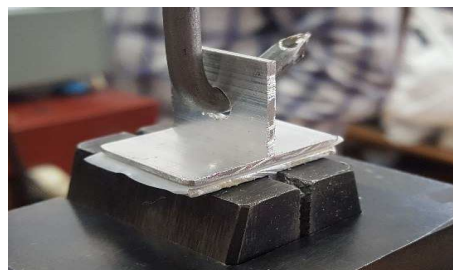
Рис. 3: Модель образца КС при испытании на растяжение по моде I
