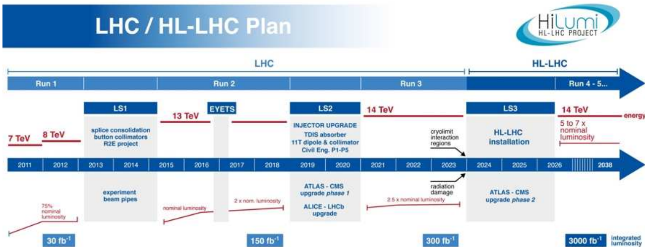
Рис. 1: План эксплуатации и модернизации БАК, включая его работу в режиме высокой светимости HL-LHC [13]
