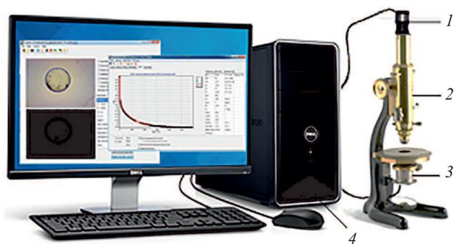
Рис. 3: Прибор для изучения набухания ПГ методом оптической микрометрии (МОМ). 1 — видеокамера в светозащитном футляре, 2 — оптический микроскоп, 3 — источник света, 4 — ПК, снабженный необходимым пакетом программ
