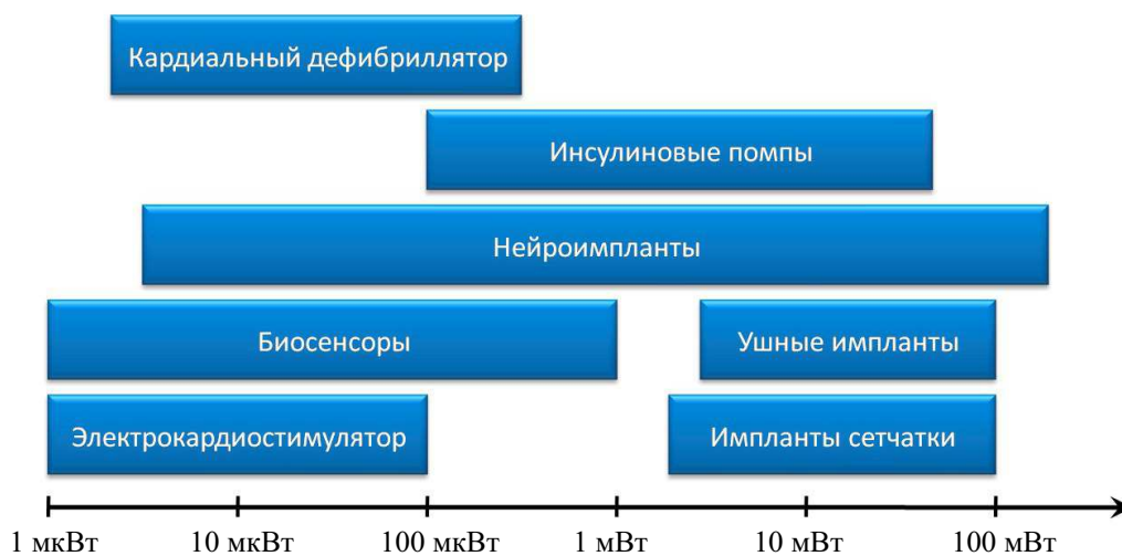
Рис. 2: Диапазоны потребляемых мощностей ИУ, кроме вспомогательного устройства для левого желудочка и искусственного сердца (3–15 Вт) [14, 18, 19]
