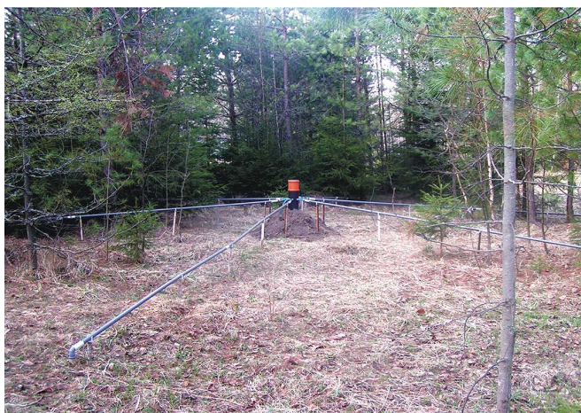
Рис. 1: Внешний вид микробарометра МБ-03 с системой ветроподавляющих фильтров на измерительной площадке Геофизической обсерватории «Михнево» ИДГ РАН
