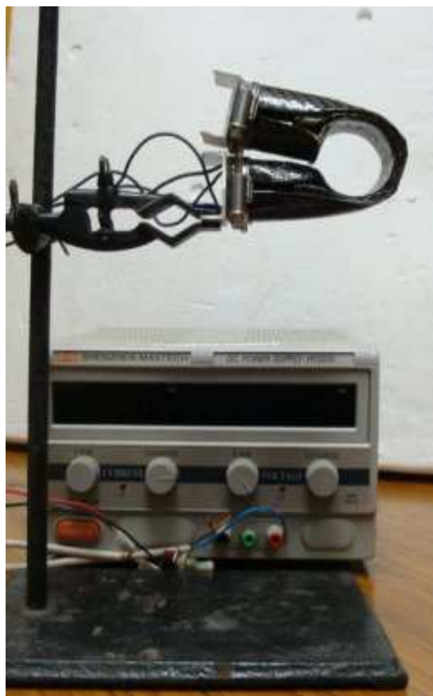
Рис. 6: Стенд для определения времени и степени восстановления формы шарнира
