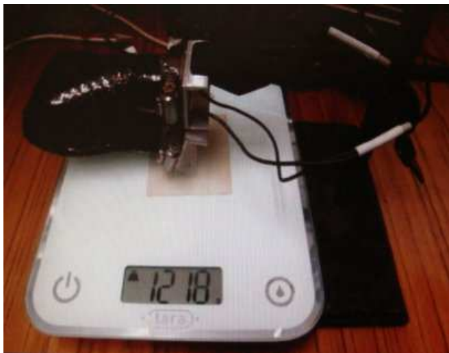
Рис. 8: Стенд для определения усилия восстановления первоначальной формы шарнира
