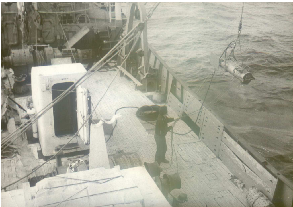
Рис. 1: Атлантика, банка Ампер. Подготовка к проведению измерений лазерным доплеровским измерителем скорости течения
