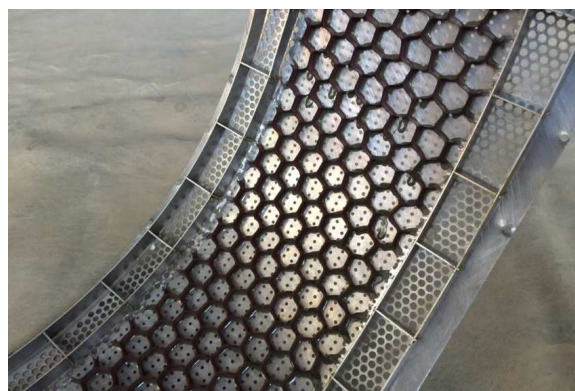
Рис. 1: Комбинированный глушитель. Вид со стороны корпуса вентилятора
