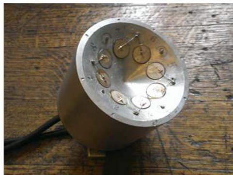
Рис. 1: Схема расположения элементов на поверхности конусного излучателя и его фотография
