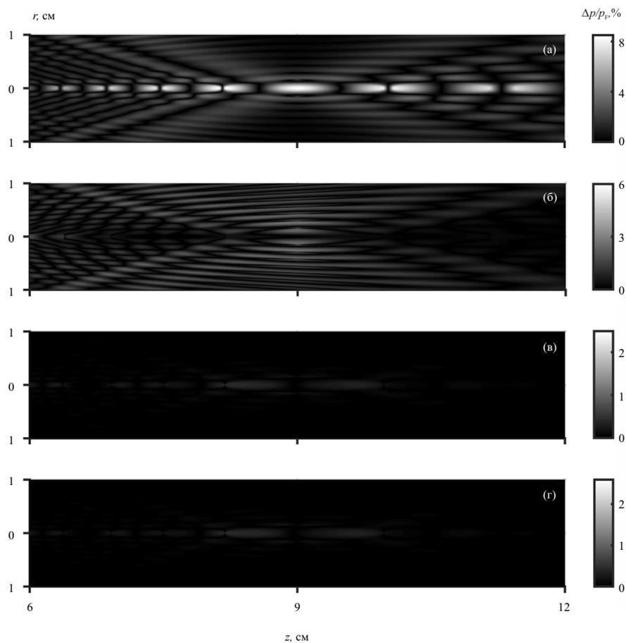
Рис. 3: Двумерное распределение разности амплитуд давлений в точном и приближенных решениях, отнесенной к амплитуде давления в фокусе в точном решении. Параболическое уравнение: *a* — со стандартным граничным условием, *б* — с модифицированным граничным условием; широкоугольное параболическое уравнение: *в* — с обратным переносом с помощью метода углового спектра, *г* — с обратным переносом с помощью широкоугольного параболического приближения
