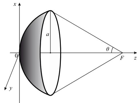
Рис. 1: Геометрия ультразвукового излучателя с апертурой  $2a$ , и фокусным расстоянием  $F$
