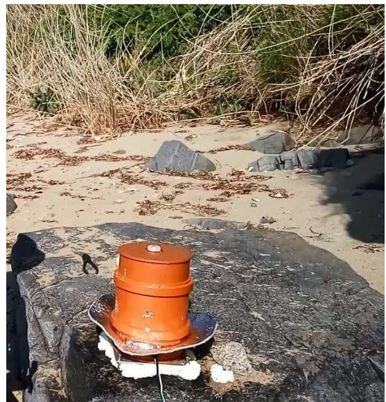
Рис. 3: Прототип волоконно–оптического сейсмоприемника на мысе Шульца (Японское море)
