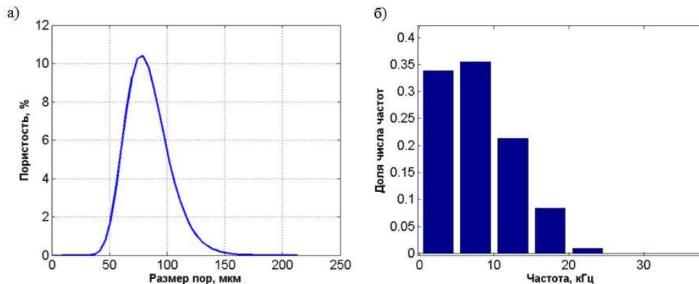
Рис. 4: а — Распределение пор по размерам Indiana Limestone с  $\mu = 4.4$ ; б — Гистограмма распределения числа собственных колебаний по частотам (с шагом 5 кГц) по логнормальному распределению (11) ( $\sigma^2 = 0.05$ ,  $\mu = 4.4$ )
