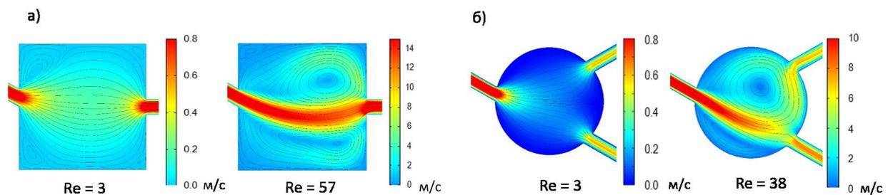
Рис. 5: Результаты численных расчетов (COMSOL Multiphysics) течения азота в двух различных двумерных геометриях пор: а — круглая геометрия; б — квадратная геометрия
