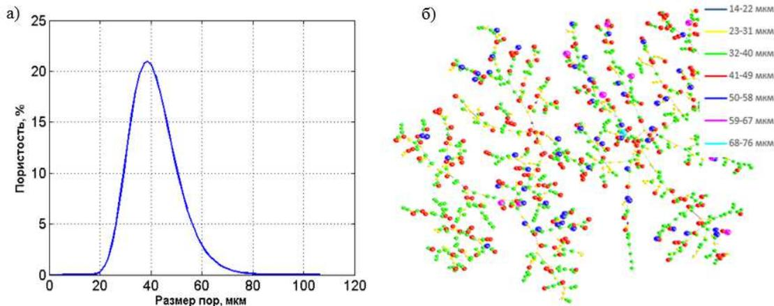
Рис. 2: а — Логнормальное распределение (11) пор по размерам Indiana Limestone ( $\sigma^2 = 0.05$ ,  $\mu = 3.7$ ); б — Визуализация ансамбля поровых резонаторов с использованием Gerhi как граф на плоскости
