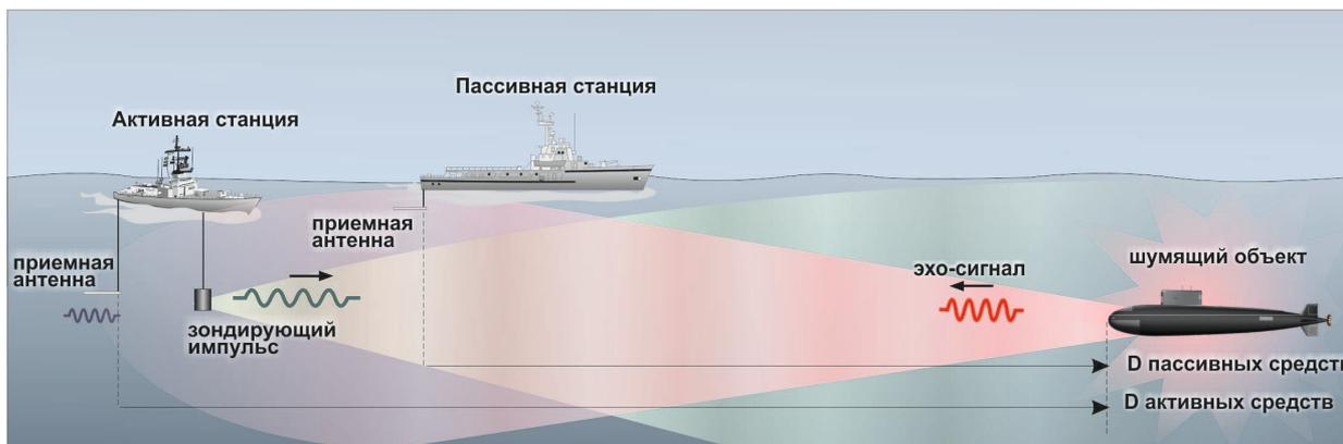
Рис. 4: Схема измерения в натуральных условиях
