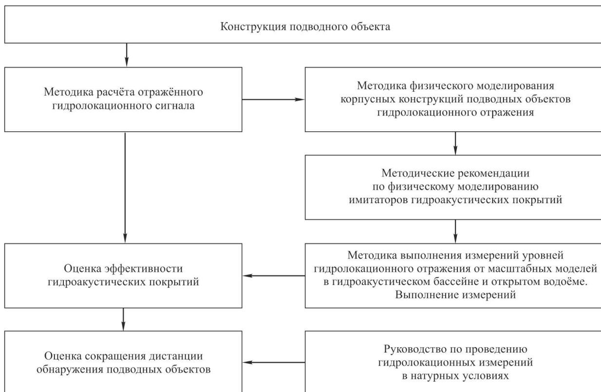
Рис. 1: Технология контроля гидролокационного отражения подводных объектов
