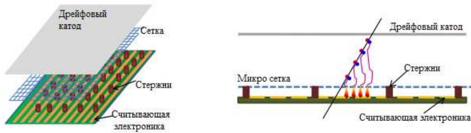
Рис. 9: Схема расположения и принцип работы детектора Micromegas [5]
