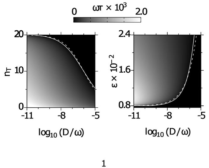
Рис. 2: (а) Распределение времени жизни запутанности в системе в зависимости от температуры окружения, определяемой  $n_T$ , и спектральной ширины шума  $D$ ; амплитуда накачки фиксирована и равна  $\varepsilon = 0.016$ . (б) Распределение времени жизни запутанности в системе в зависимости от амплитуды параметрической накачки  $\varepsilon$  и спектральной ширины шума  $D$ , при фиксированной температуре, для которой  $n_T = 10$
